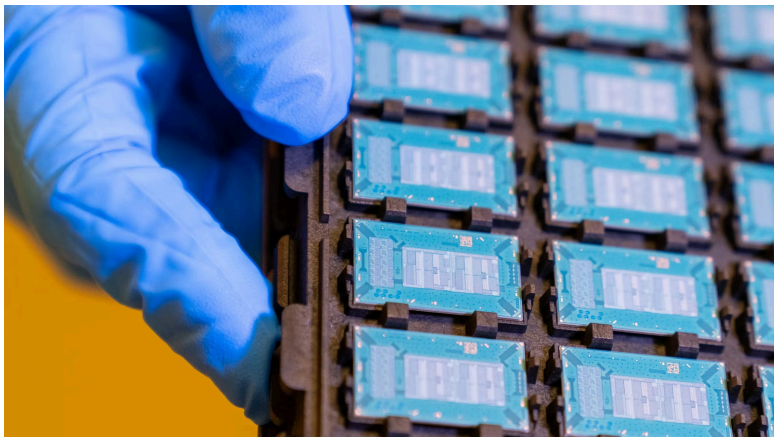
圖為2023年7月，位於亞利桑那州Chandler的英特爾組裝與測試技術開發工廠的玻璃基板測試裝置。英特爾先進封裝技術在公司的組裝與測試技術開發工廠得以實現。（圖片來源：英特爾公司）
