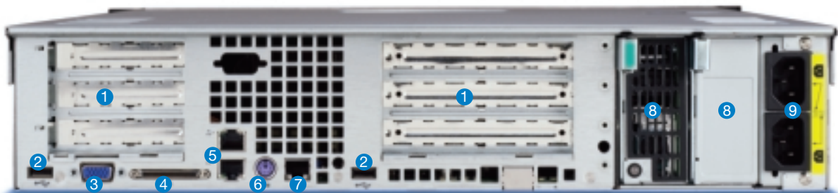
インテル® サーバ・シャーシ SR2300 に 1+0 500W 電源を装備したときの背面パネル
